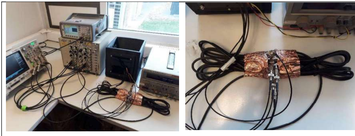
Fig. A.2.1 Montaje experimental y línea de retardo discreta.
