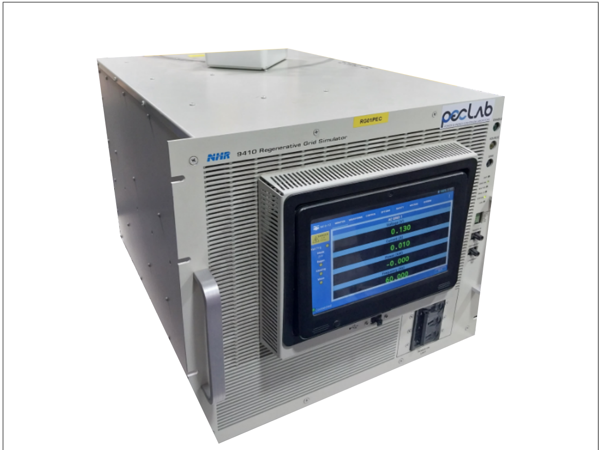
Figura J.1. Fuente de potencia bidireccional NHR 9411 utilizada en el puerto dc1.
