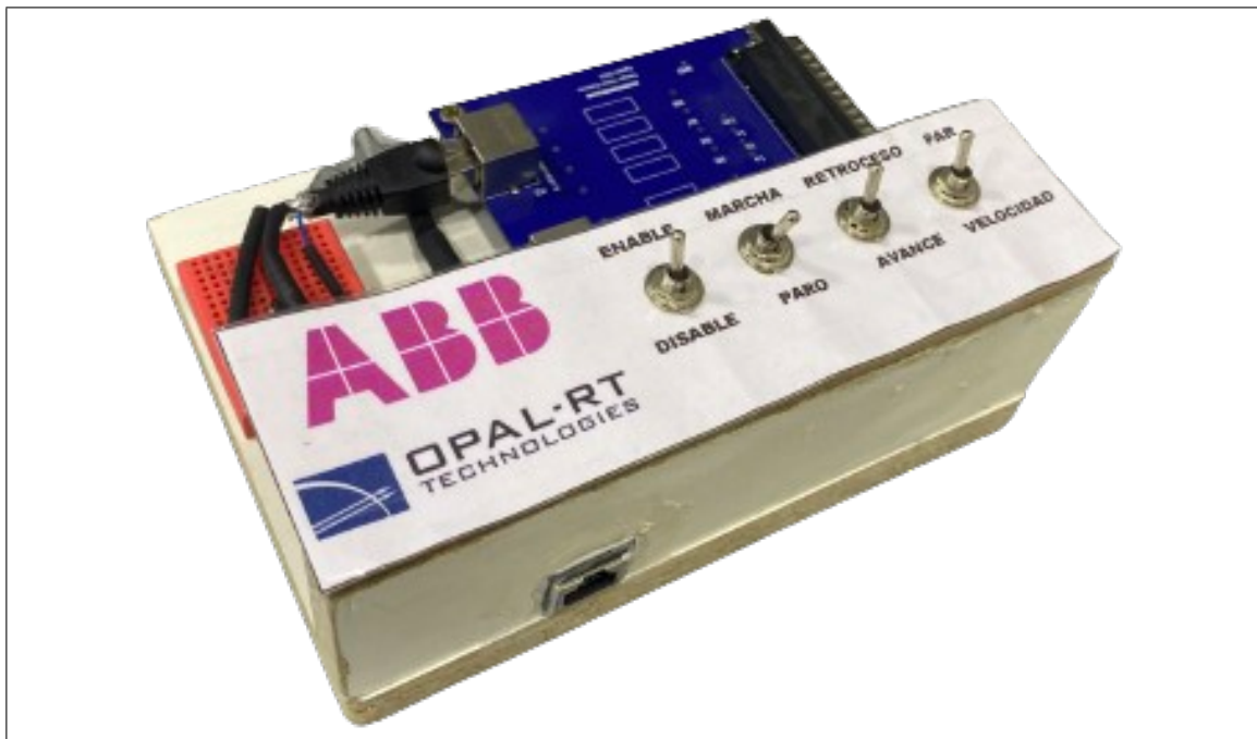
Figura G.5. Módulo adaptador de comunicación entre el controlador principal OP4510 y el variador de frecuencia ACS800.
